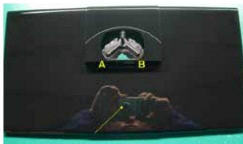
图3 32DH66脚架两个浇口进胶(A、B两点)
